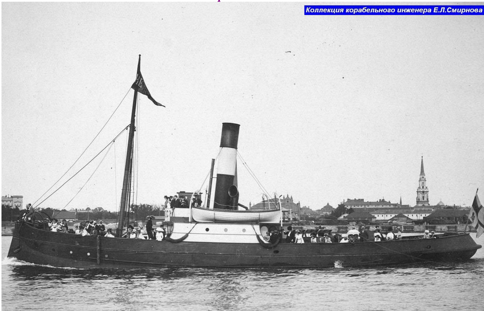
Буксир ГЕРКУЛЕС с ледорезным усилением форштевня и носовых скуловых поясьев обшивки
