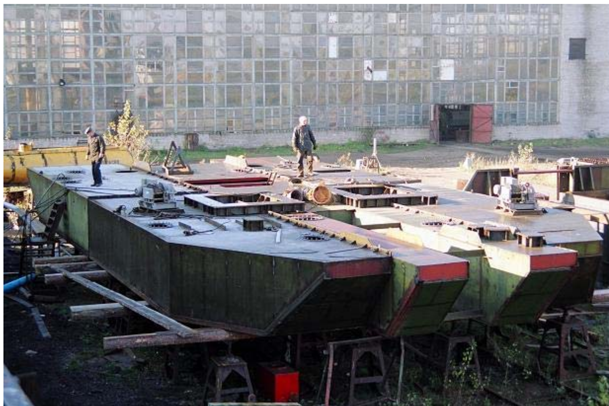
Сборка секционного корпуса
